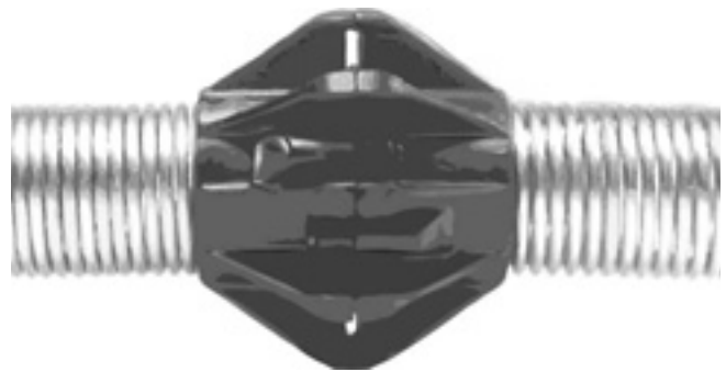
Figure 24 – Les guides de centrage améliorent la visibilité en permettant à la caméra d’assurer un balayage uniforme de toutes les parois de la canalisation, et en la maintenant surélevée par rapport aux boues du fil d’eau. Aussi réduisent-ils l’usure de la fenêtre à DEL.
