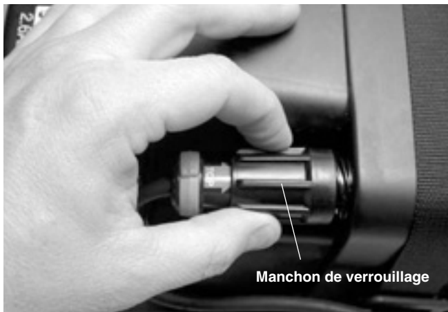
Figure 13 – Vissage du manchon de verrouillage
