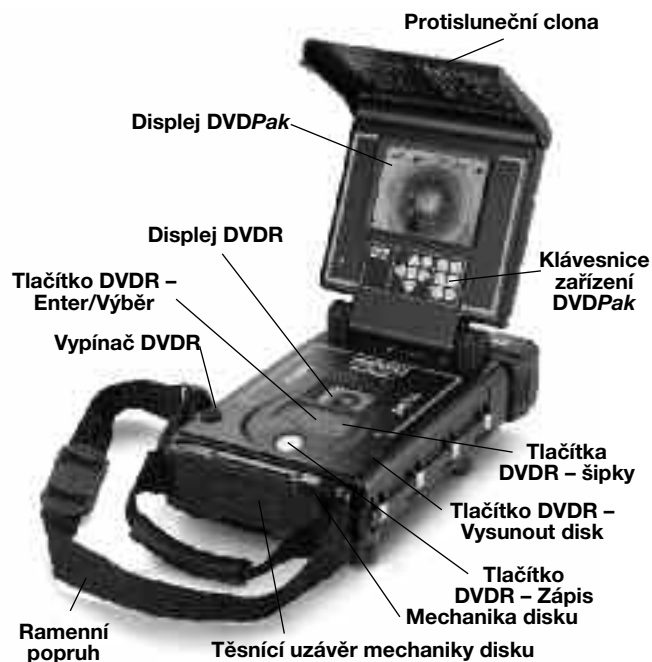
Obrázek 1 – Součásti zařízení DVDPak
