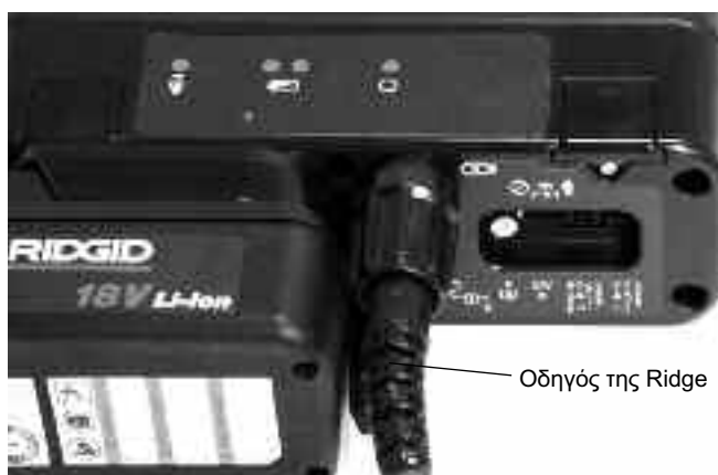
Εικόνα 4 – Σύνδεση της πρίζας συστήματος στη θύρα συστήματος του DVDPak
