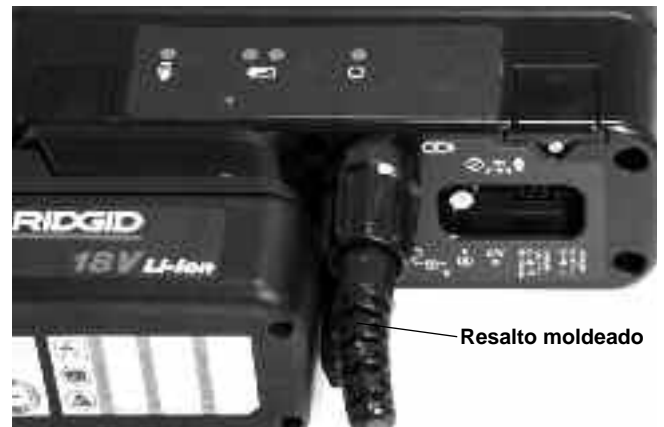
Figura 4 – Conexión del enchufe del cable SeeSnake al conector del Sistema SeeSnake en el DVDPak
