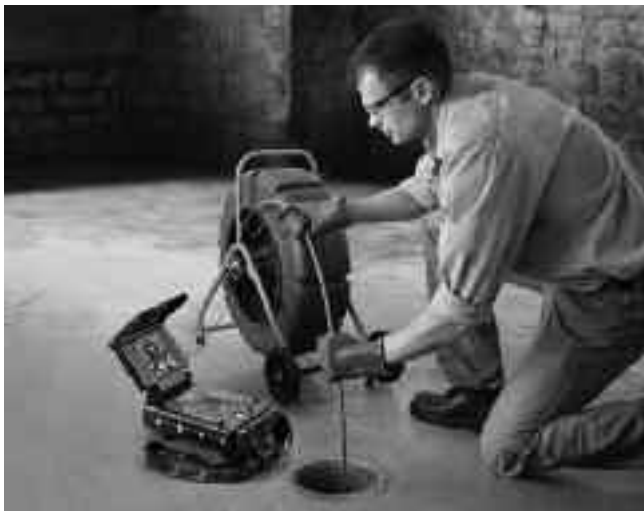
Figura 5 – DVDPak con una Limpiadora de Desagües SeeSnake
