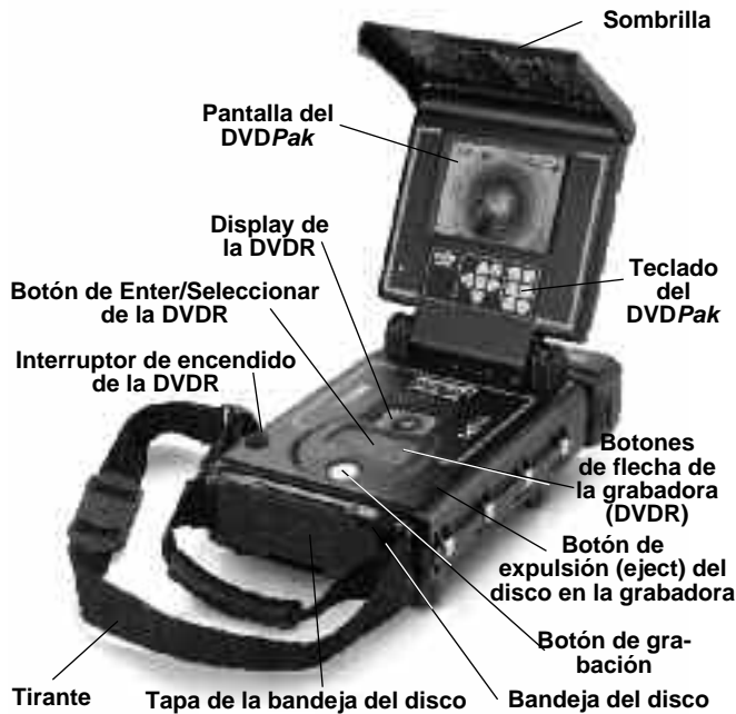
Figura 1 – Componentes del DVD Pak
