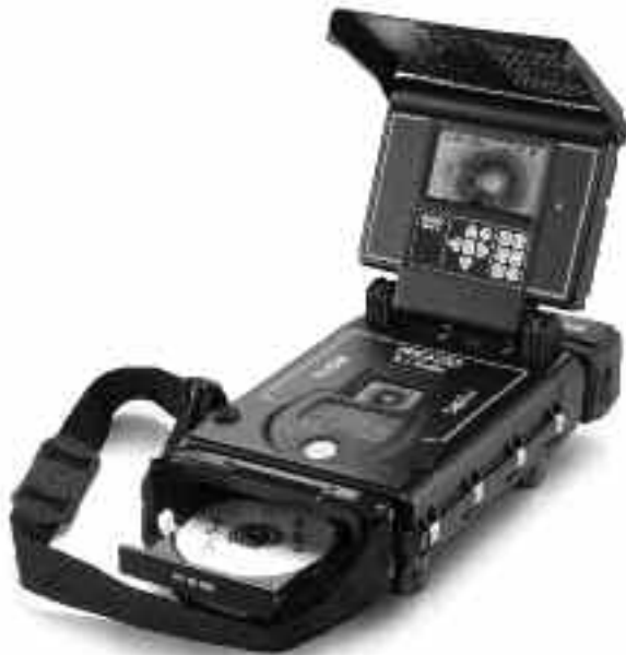
Figura 11 – Bandeja del disco DVD abierta
