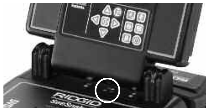
Figura 7 – DELs indicadores del estado de la pila
