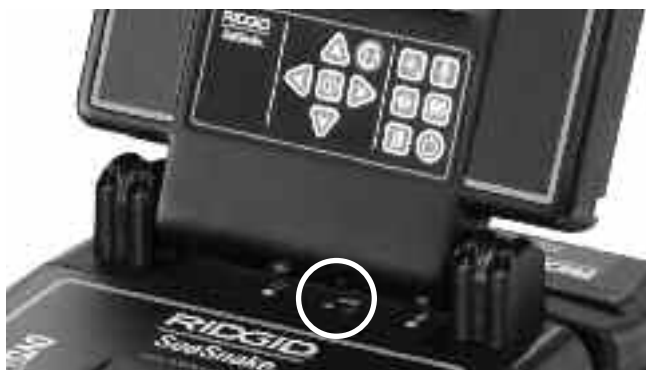
Figuur 7 – Leds batterijstatus
