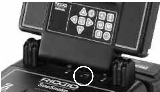
Slika 7 – LED indikator stanja baterije
