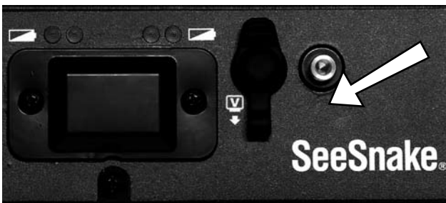
Εικόνα 13: Ακροδέκτης σύνδεσης πομπού της οθόνης LCDPak
