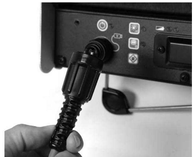
Εικόνα 9: Σύνδεση του βύσματος του συστήματος στην θύρα συστήματος SeeSnake
