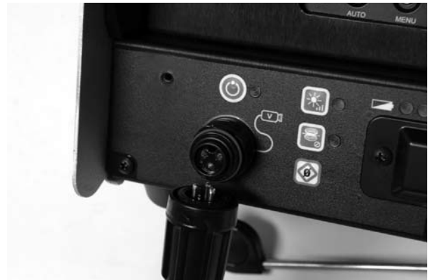
Εικόνα 8: Ευθυγράμμιση βύσματος καλωδίου συστήματος
