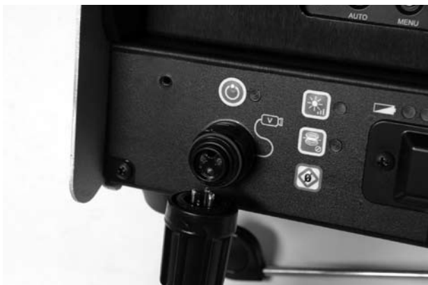
Kuva 8: Järjestelmäkaapelin pistokkeen kohdistaminen
