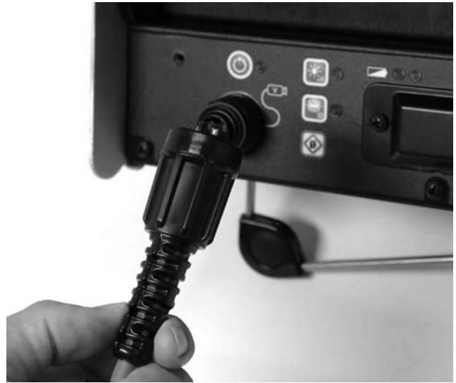
Kuva 9: Järjestelmän pistokkeen kytkeminen SeeSnake-järjestelmän liittimeen
