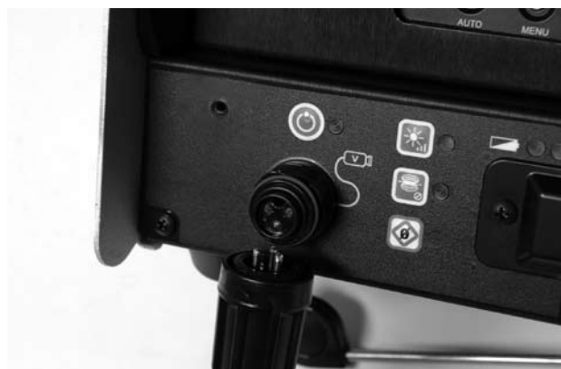
Figura 8: allineamento dei connettori
