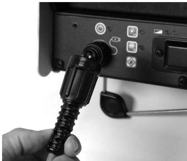
Figura 9: Collegamento del connettore della ruota SeeSnake al monitor
