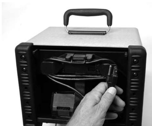
Figura 10: cavo di alimentazione e supporto avvolgi cavo
