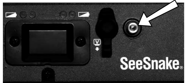
Figura 13: terminale del trasmettitore con fissaggio a clip dell'LCDPak
