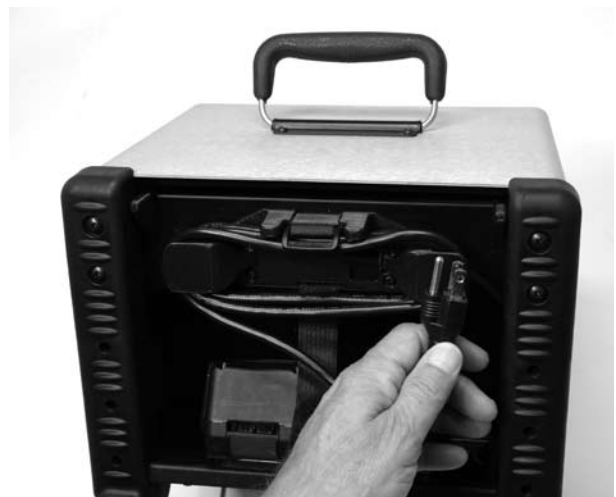
Figura 10: Cablul de alimentare și sistemul de înfășurare
