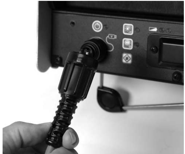
Figura 9: Conectarea cuplei sistemului la conectorul sistemului SeeSnake
