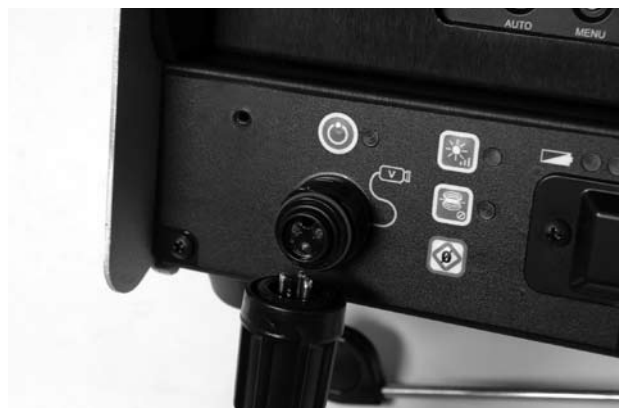
Figura 8: Alinierea cuplei cablului sistemului
