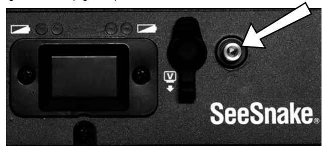
Figura 13: Terminalul de atașare a emițătorului de pe dispozitivul LCDPak
