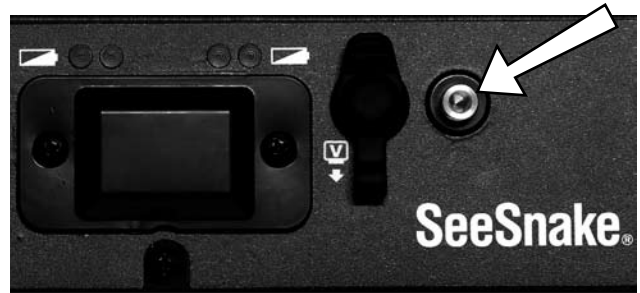
Skica 13 LCDPak Priključek oddajnika, ki se pritrdi z zateznikom
