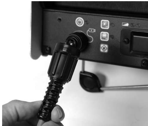
Figur 9: Anslutning av systemkontakten till kontaktdonet för SeeSnake-systemet
