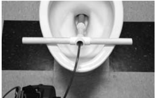
Figura 24 – Empleo de un tubo-guía de PVC
