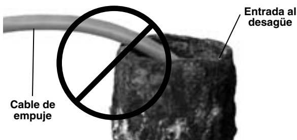
Figura 18 – Evite raspar el cable contra bordes afilados
