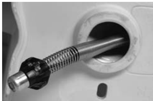
Figura 22 – Cámara que logró pasar la curva
