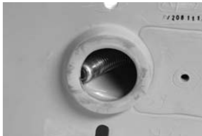
Figura 20 – Cámara atascada en una curva
