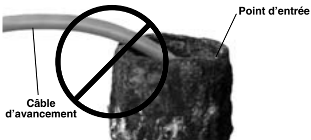
Figure 18 – Éviter d'appuyer contre le rebord
