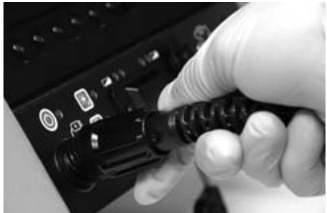
Figure 13 – Branchement sur CCU SeeSnake
