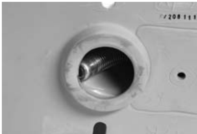
Figure 20 – Tête de caméra bloquée dans un coude
