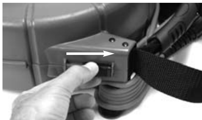
Рис. 4. Отстегивание корпуса барабана microDrain
