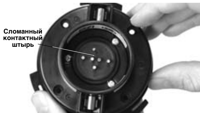
Рис. 7. Сломанный контактный штырь
