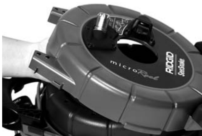
Obrázek 5 – Opatrné otevírání bubnu pro nasměrování kabelu
