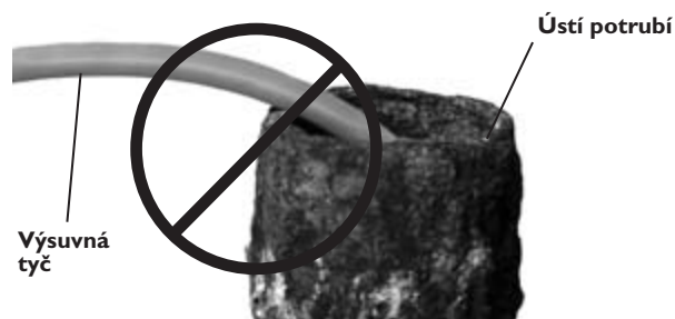
Obrázek 23 – U ostrých úhlů postupujte opatrně
