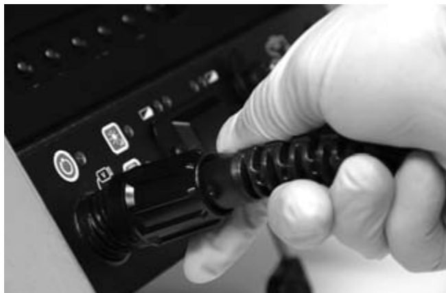
Figur 17 – Tilslutning til en SeeSnake KKE
