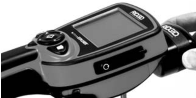
Figur 14 – Tilslutning af microEXPLORER-kameramonitoren
