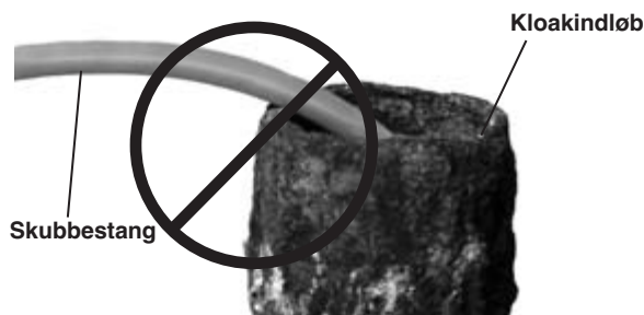
Figur 23 – Undgå at trække i skarpe vinkler
