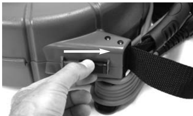
Figur 4 – Oplåsning af microReel-beklædningen
