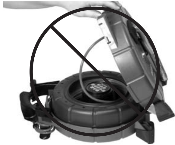
Abbildung 10 – Kabel nicht unkontrolliert herausfedern lassen
