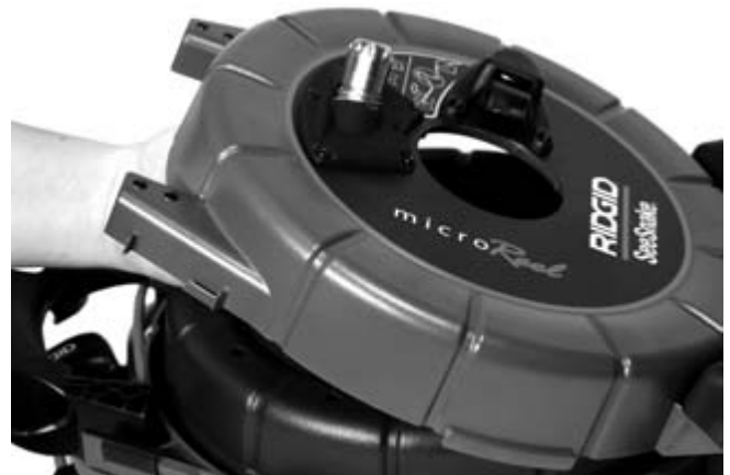
Abbildung 5 – Trommel vorsichtig öffnen, um das Kabel zu führen
