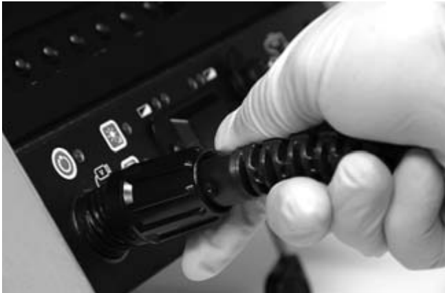
Abbildung 17 – Anschließen an eine SeeSnake CCU
