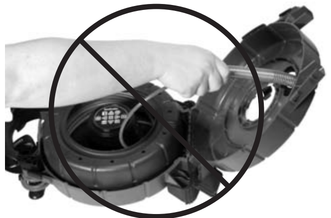
Εικόνα 6 – Μην ανοίγετε τελείως τη θήκη
