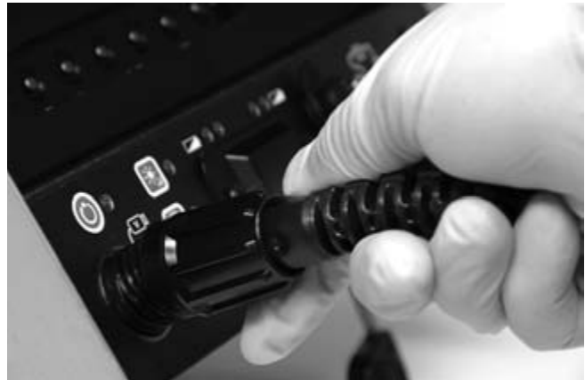
Εικόνα 17 – Σύνδεση σε μονάδα CCU SeeSnake
