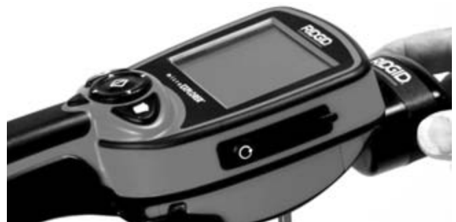
Εικόνα 14 – Σύνδεση του μόνιτορ της κάμερας microEXPLORER
