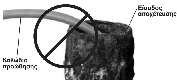
Εικόνα 23 – Μην τραβάτε υπό οξεία γωνία
