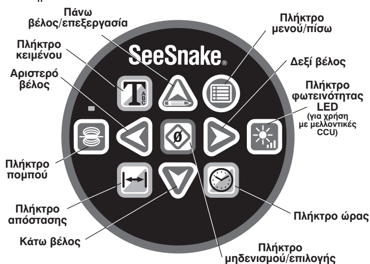
Εικόνα 20 – Πληκτρολόγιο προαιρετικού μετρητή CountPlus
