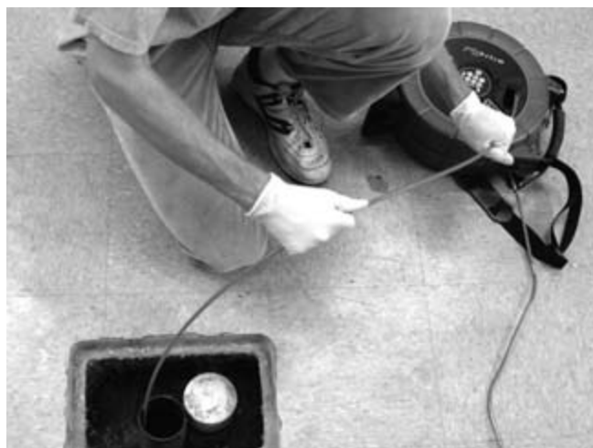
Slika 28 – Prikladna tehnika za guranje kabela natrag u bubanj
