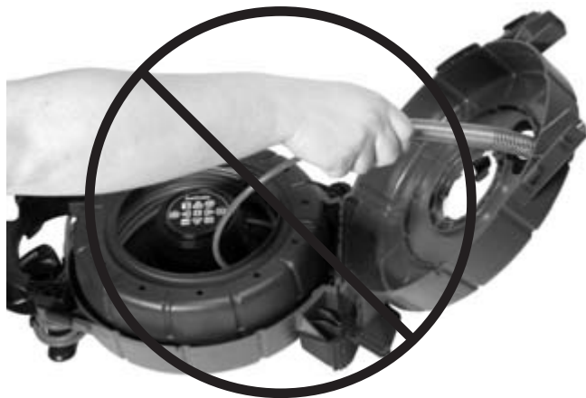
Crtež 6 – Ne otvarajte kućište do kraja
