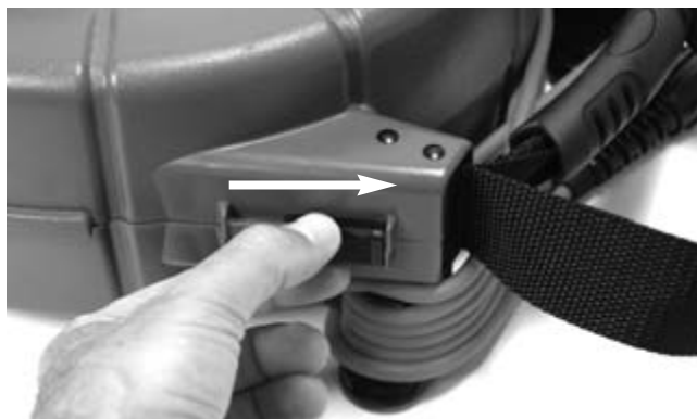
4. ábra – A microReel tokozás kioldása
