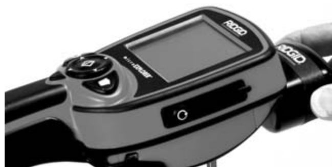
Figuur 14 – Aansluiten van de microEXPLORER-cameramonitor
