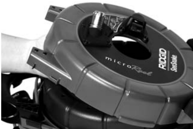
Figuur 5 – Open haspel voorzichtig om kabel te leiden
