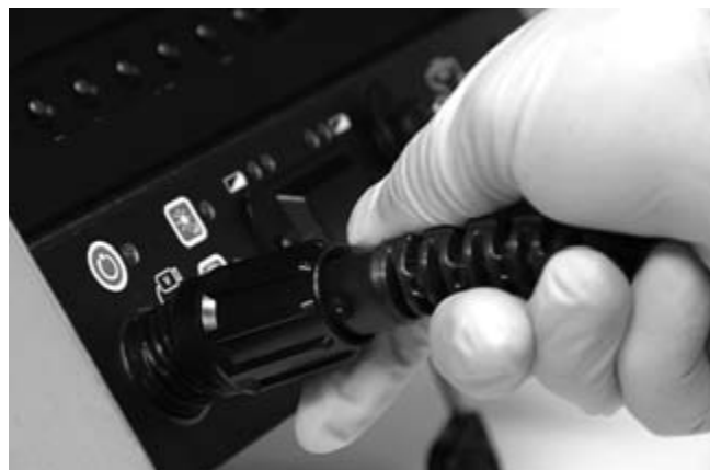
Rysunek 17 – Podłączanie do jednostki CCU SeeSnake
