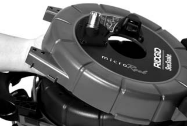
Rysunek 5 – Ostrożnie otwierać bęben przy prowadzeniu przewodu.
