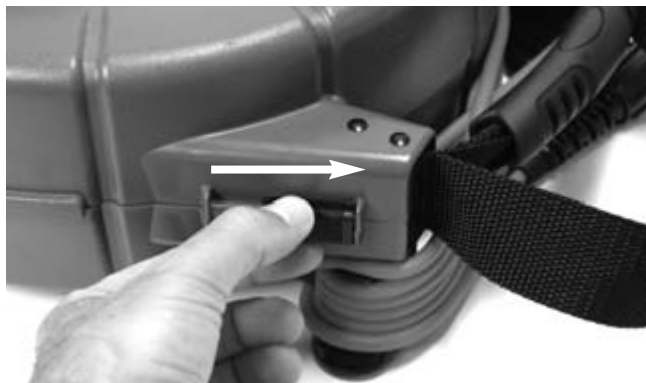
Figura 4 – Destrancar a Caixa do microReel
