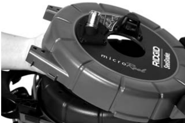
Figura 5 – Abra o tambor cuidadosamente para encaminhar o cabo
