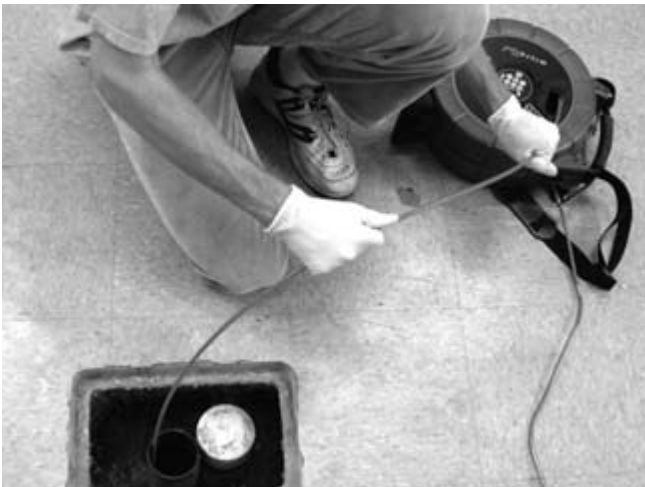
Figura 28 – Técnica Adequada para Puxar o Cabo de Volta para o Tambor
