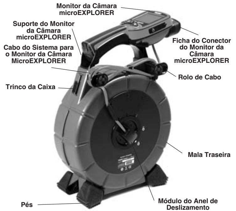
Figura 2 – Vista Traseira (Configuração do monitor da Câmara microEXPLORER)
