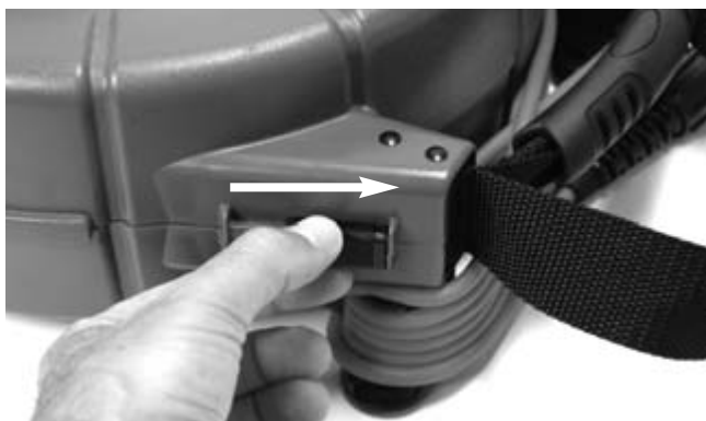
Figura 4 – Deschiderea carcasei microReel
