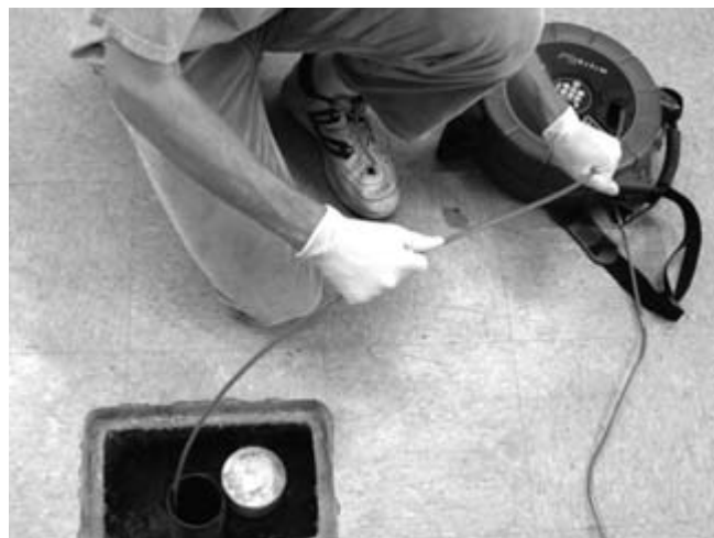
Рис. 28 – Надлежащий метод проталкивания кабеля назад в барабан
