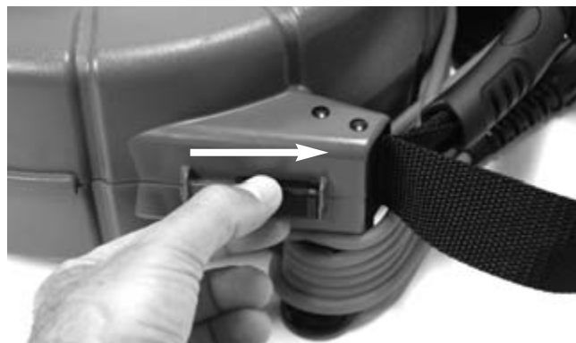
Рис. 4 – Освобождение защелок корпуса прибора microReel
