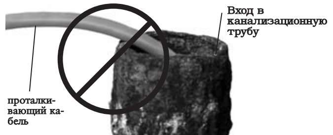
Рис. 23 – Не следует вытягивать кабель по острым кромкам
