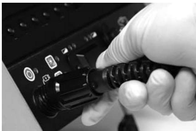
Obrázok 17 – Pripojenie sa na CCU jednotku SeeSnake
