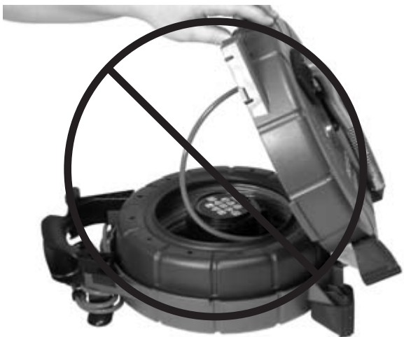
Obrázok 10 – Nedovoľte, aby sa kábel voľne odvíjal.
