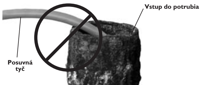
Obrázok 23 – Vyhýbajte sa ťahaniu pod ostrými uhlami
