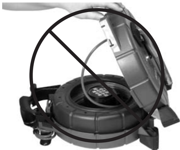
Figur 10 – Låt inte kabeln rullas av fritt
