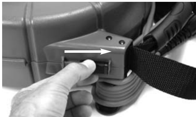
Figur 4 – Lossa spärrarna till microReel-höljet
