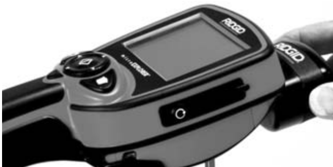
Figur 14 – Ansluta microEXPLORER-systemets kamerabildskärm
