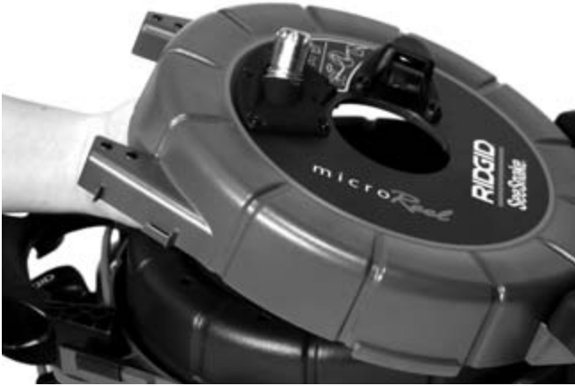
Şekil 5 – Kabloyu Yönlendirmek İçin Tamburu Dikkatli Açma
