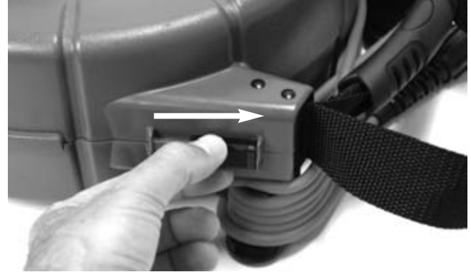
Şekil 4 – microReel Muhafazasının mandallarını açma
