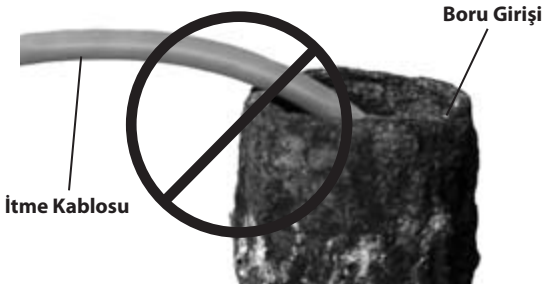
Şekil 23 – Keskin Açılarda Çekmekten Kaçınım
