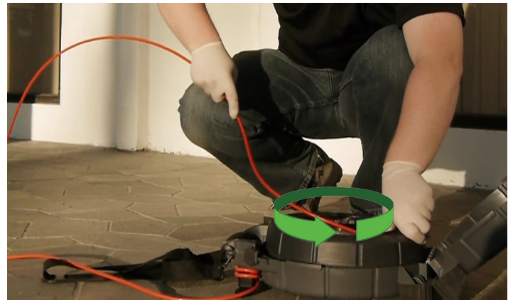
Kuva 4 – Työntökaapelin ohjaaminen haspeliin
