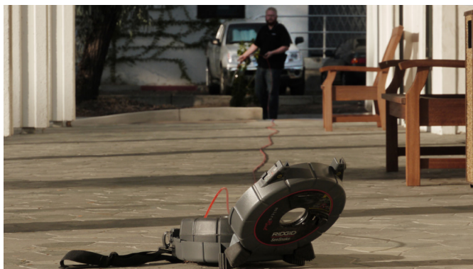
Рисунок 2 – Выпрямление проталкивающего кабеля
