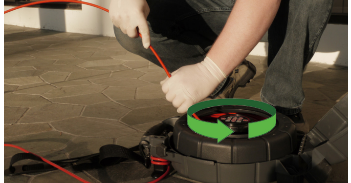
Εικόνα 3 – Περιστρέφοντας το τύμπανο ώστε να τυλιχθεί σωστά το καλώδιο προώθησης
