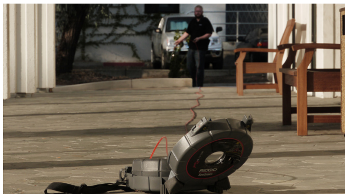
Figura 2 – Întinderea cablului împingător
