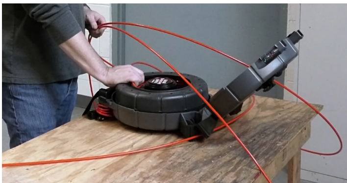
Obrázok 1 – Bubon správne vložený v puzdre
