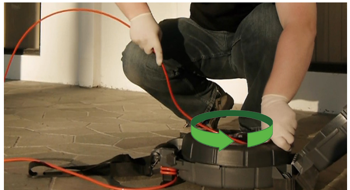
Εικόνα 4 – Καθοδηγώντας το καλώδιο προώθησης μέσα στο τύμπανο
