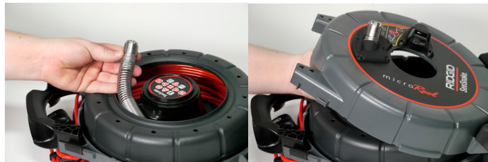
Ábra 5 – A kamerafej vezetése
