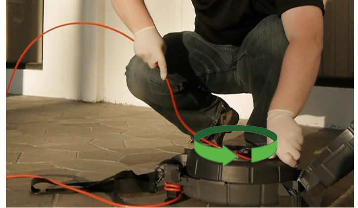
Şekil 4 – İtme kablosunun tambura sokulması
