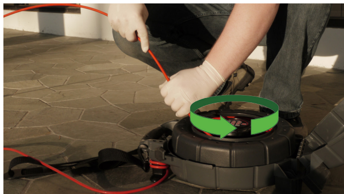
Sliku 3 – Rotiranje bubnja da bi se pritiskajući kabal pravilno namotao
