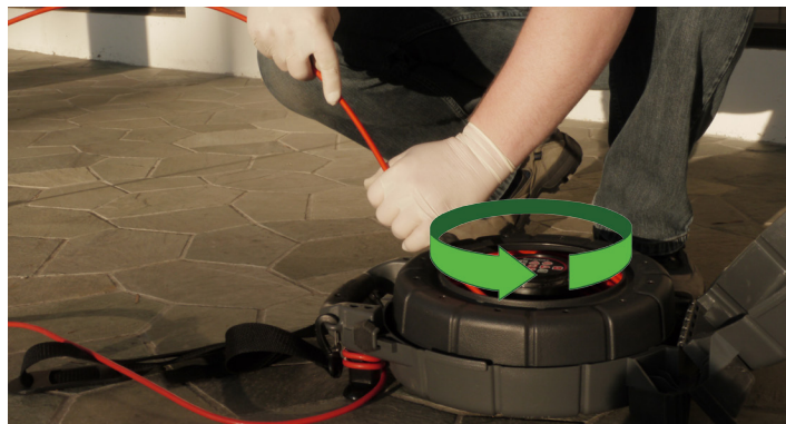
Abbildung 3 – Drehen der Trommel um das Schubkabel korrekt ab- und aufzuspulen
