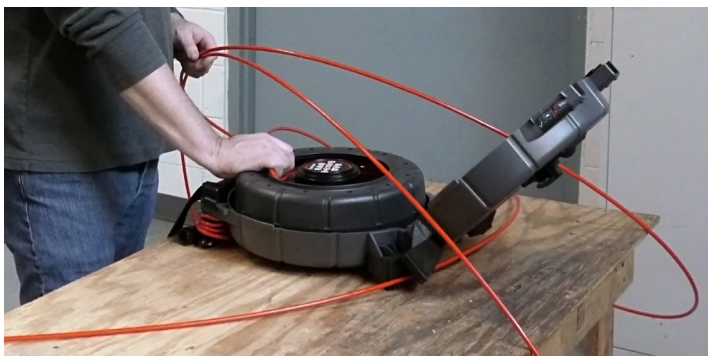
Ábra 1 – A tekercs helyes fekvése a dobozban
