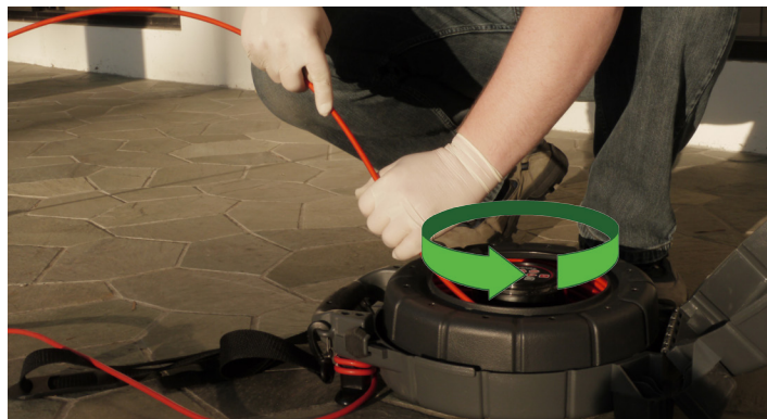
Afbeelding 3 – De haspel draaien om de duwkabel op de juiste manier op te winden
