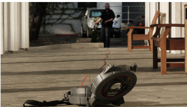
Εικόνα 2 – Ισιώνοντας το καλώδιο προώθησης
