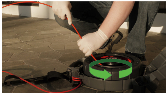
Ábra 3 – A tekercs forgatása a toló-kábel helyes feltekerésére
