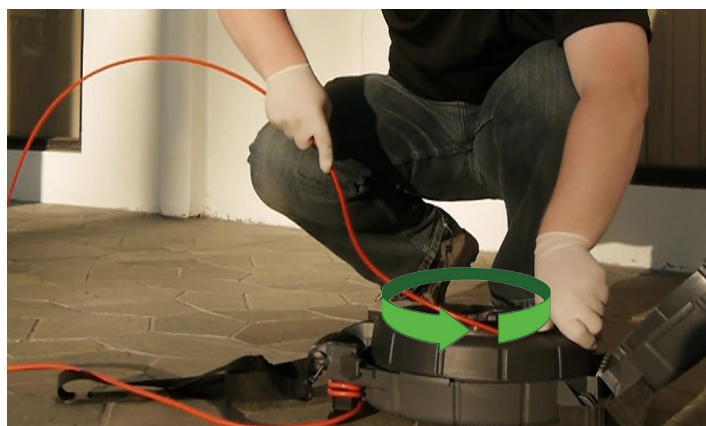
Sliku 4 – Navođenje pritiskajućeg kabla u bubanj
