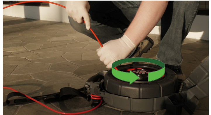
Kuva 3 – Haspelin pyörittäminen työntökaapelin kelaamiseksi oikein
