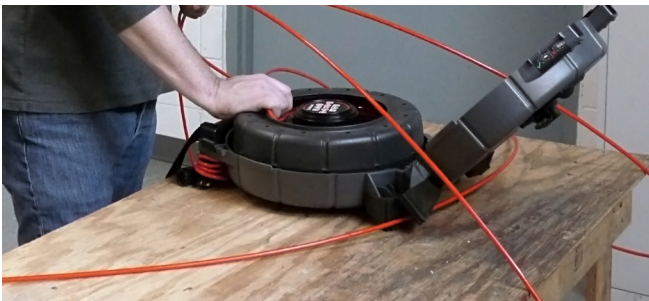
Εικόνα 1 – Το τύμπανο σωστά τοποθετημένο στην υποδοχή
