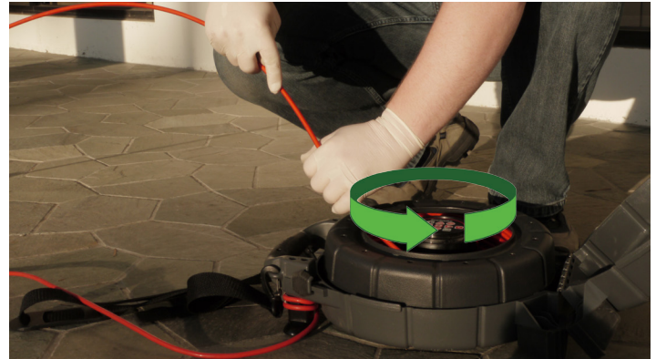
Figura 3 – Come girare il tamburo per riavvolgere il cavo di spinta in modo corretto
