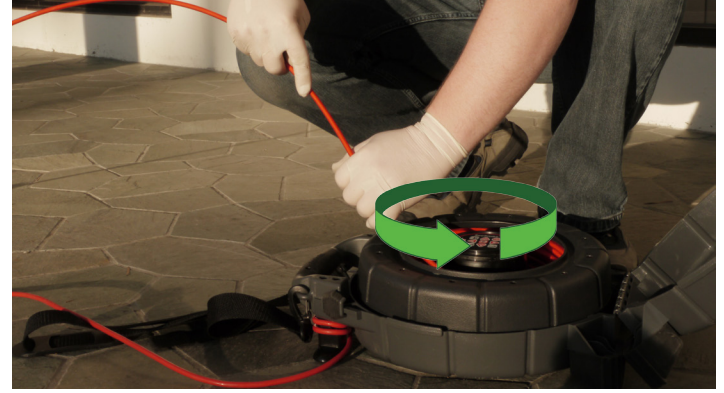
Şekil 3 – İtme kablosunu tam olarak sarmak için tamburun döndürülmesi
