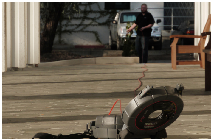
Ábra 2 – A toló-kábel kiegyenesítése
