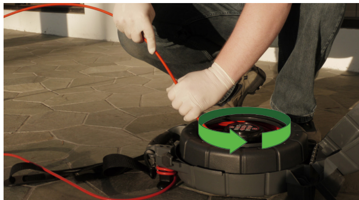
Figur 3 – Roter trommelen for å ordentlig spole push-kabelen
