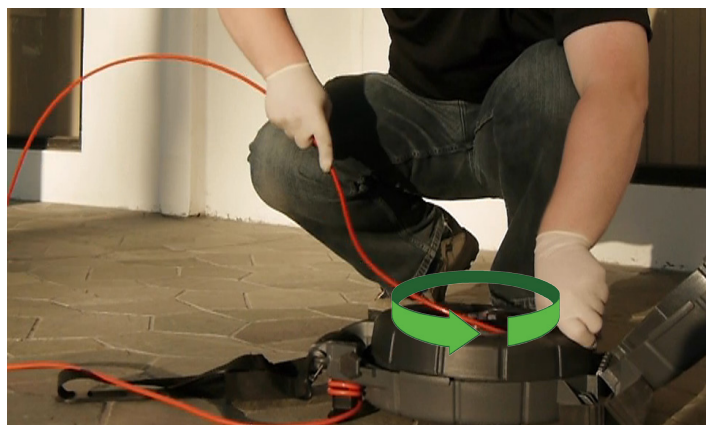
Obrázek 4 – Vedení kabelu při navíjení na buben
