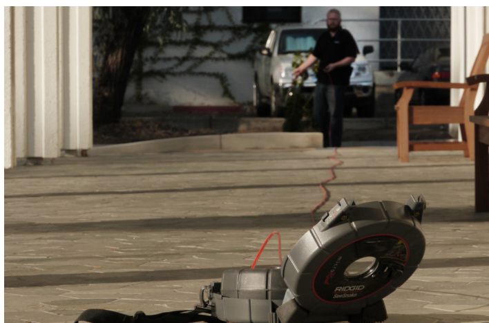
Obrázok 2 – Vyrovnanie tlačného kábla
