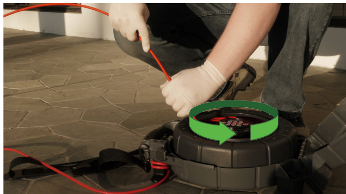
Figura 3 – Sensul de rotire tamburului, pentru a asigura încolăcirea corectă a cablului împingător
