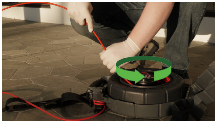
Figure 3 – Faire tourner le tambour pour un enroulage correct du câble de poussée
