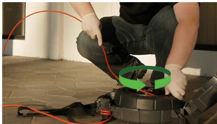
Sliku 4 – Navođenje kabela za pritiskanje u bubanj
