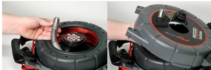
Obrázek 5 – Vedení hlavy kamery
