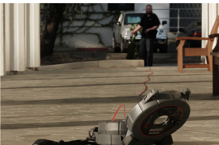
Figura 2 – Estiramiento del cable de empuje
