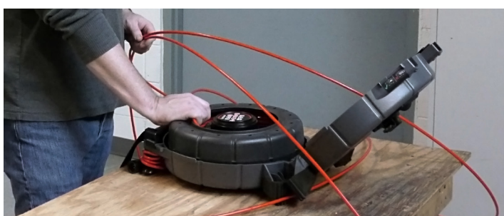
Abbildung 1 – Richtiges Einsetzen der Trommel im Gehäuse
