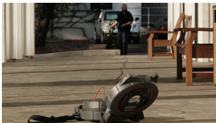
Afbeelding 2 – De duwkabel rechtmaken
