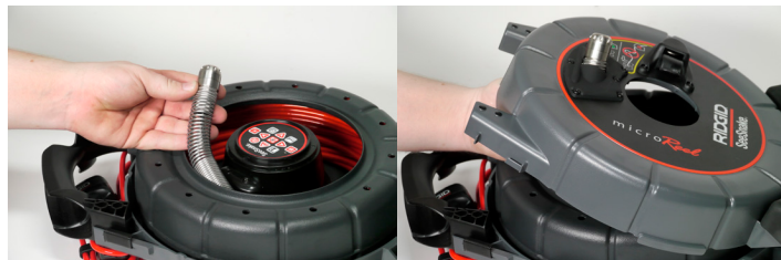
Abbildung 5 – Verlegung des Kamerakopfes
