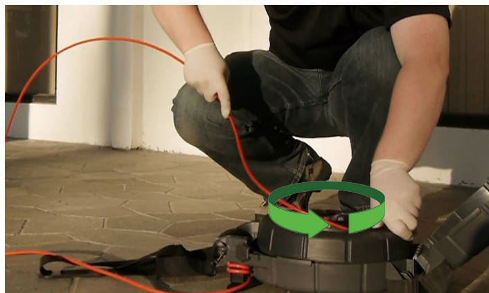
Figur 4 – At føre skubbekablet ind i tromlen
