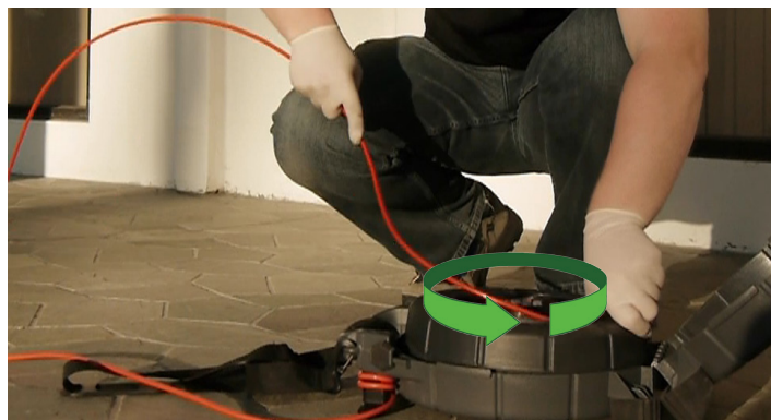
Afbeelding 4 – De duwkabel in de haspel leiden
