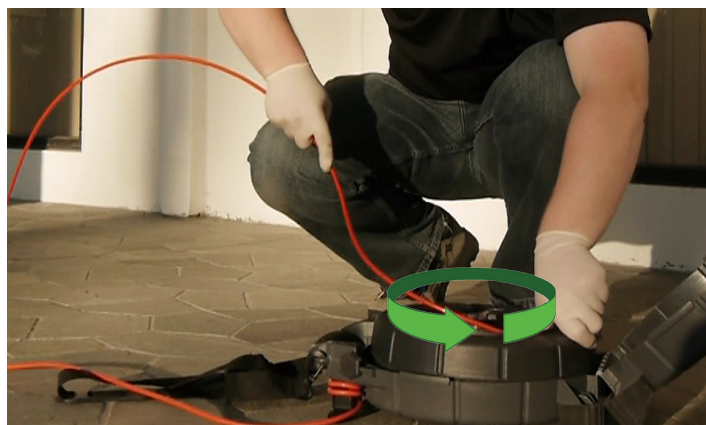
Figur 4 – Led push-kabelen inn i trommelen
