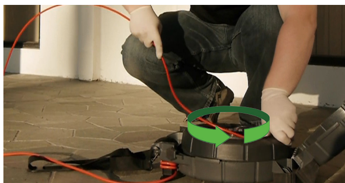
Abbildung 4 – Einführen des Schubkabels in die Trommel
