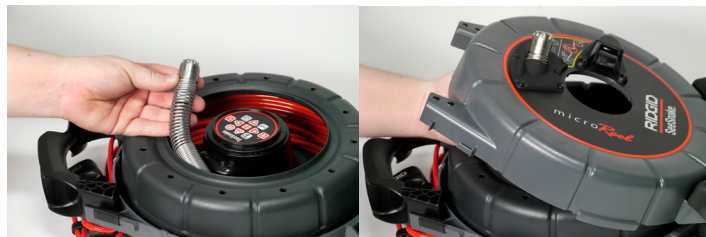
Figur 5 – Ruting av kameraets hode
