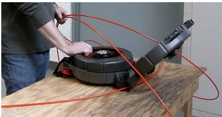
Figura 1 – Tambor inserido corretamente no estojo
