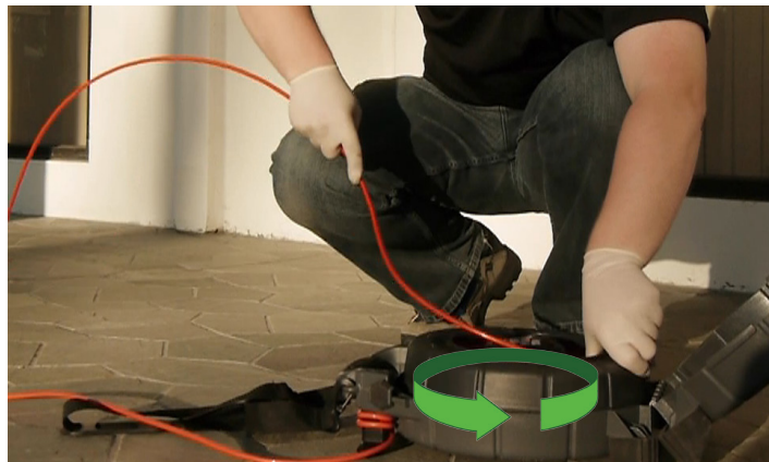
Ábra 4 – A toló-kábel feltekerése a tekercsre
