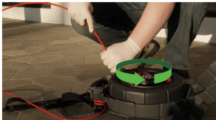
Sliku 3 – Rotiranje bubnja da bi se ispravno namotao kabel za pritiskanje
