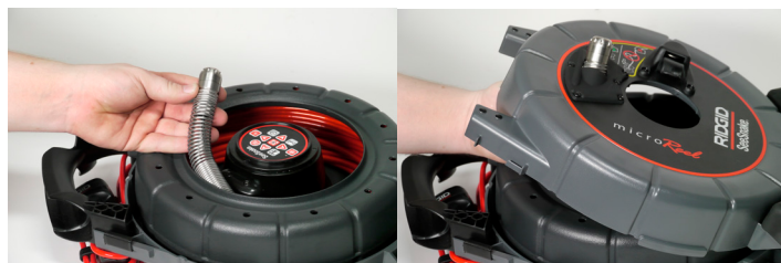
Figure 5 – Routage de la tête de caméra
