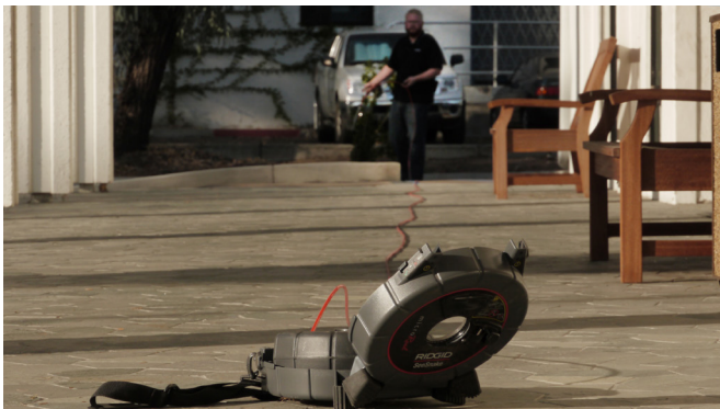
Figura 2 – Stendere il cavo di spinta
