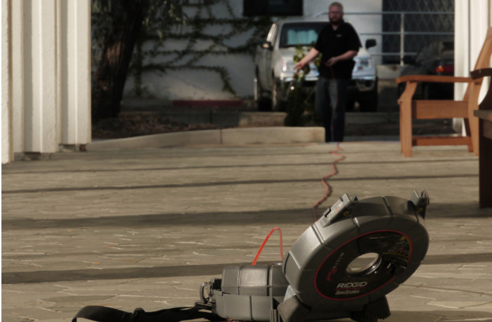
Şekil 2 – İtme kablosunu düzleme
