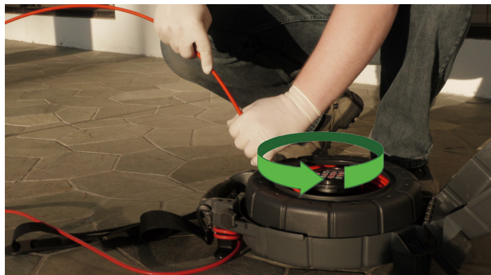
Figur 3 – Rotering af tromlen for at vikles skubbekablet korrekt
