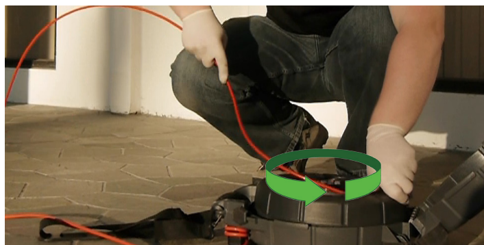
Rysunek 4 – Wprowadzanie przewodu popychacza do bębna
