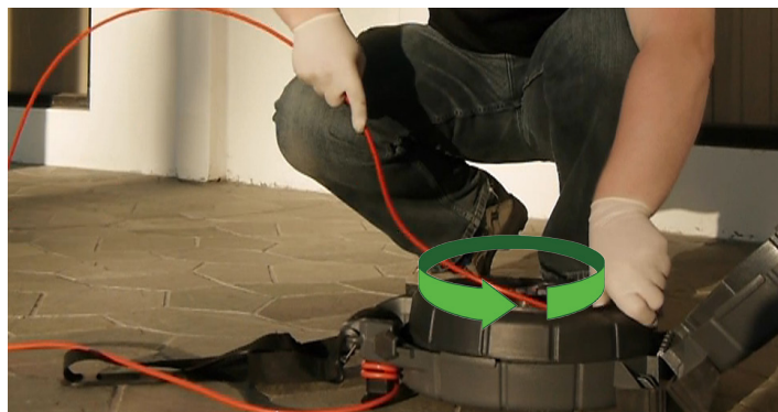
Figura 4 – Ghidarea cablului împingător în tambur
