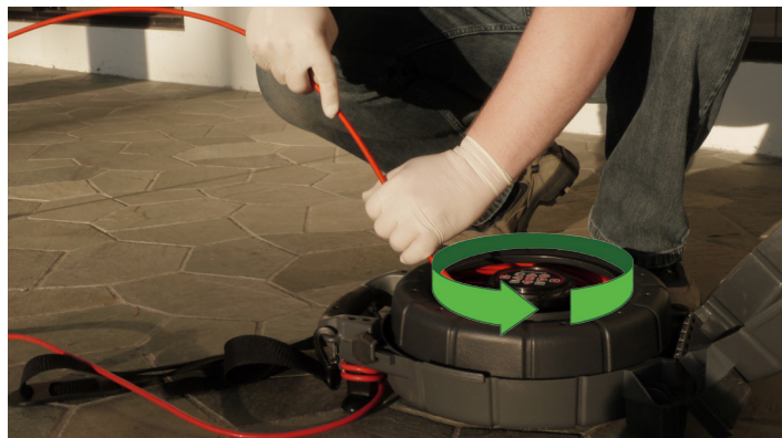
Obrázok 3 – Otáčanie bubna pre správne navinutie tlačného kábla
