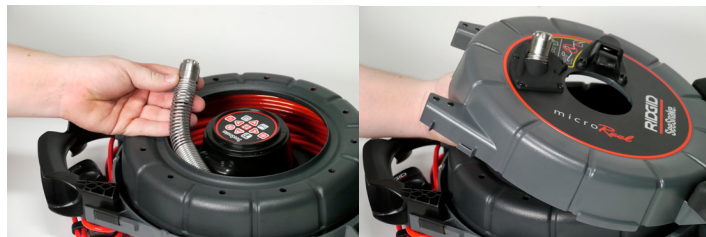
Рисунок 5 – Укладка головки камеры
