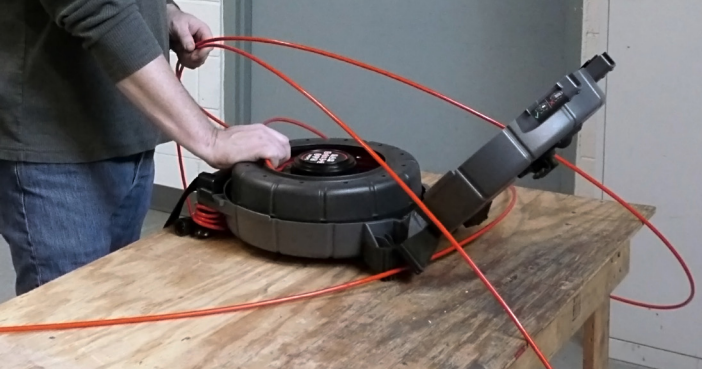
Şekil 1 – Tambur tam olarak kutunun içine oturuyor
