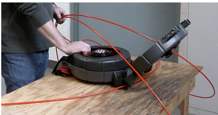
Obrázek 1 – Správně umístěný buben v pouzdře
