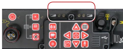
Figure 10 – Indicateurs de piles LED
