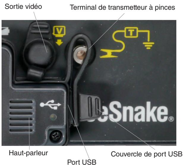
Figure 5 – Connexions du CS10
