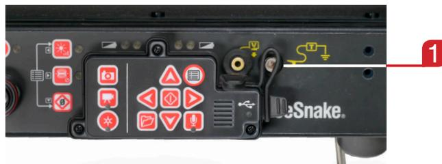
Figure 13 – Terminal de transmetteur à pinces du CS10
