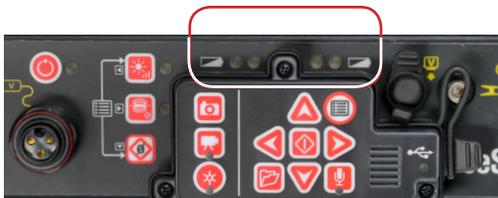
Figura 10 – LEDs indicadores da bateria
