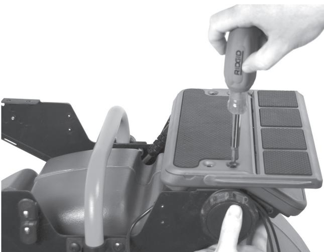
**Abbildung 13 – Montieren der rechten Plattform**
