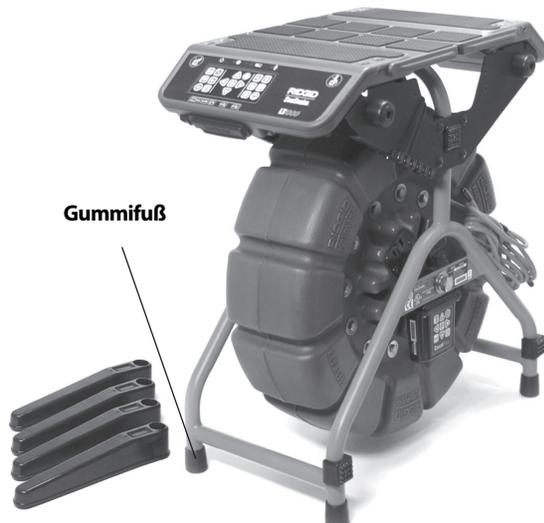
**Abbildung 18 – Stabilisatoren mit Mini-Trommel**
