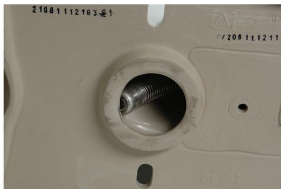
**Figura 16 – Cabeça da câmera bloqueada em uma curva**
