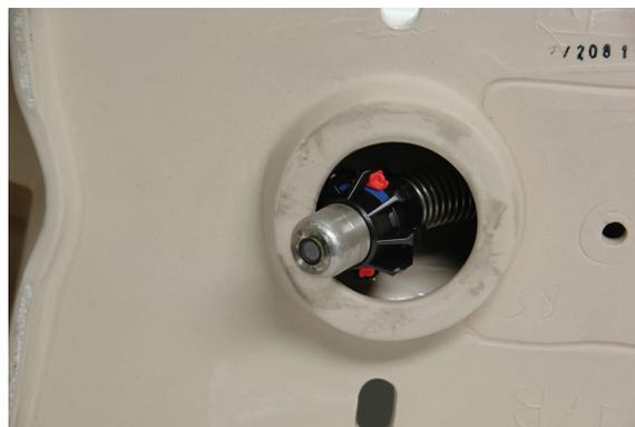
**Figura 17 – Cabeça da câmera com guia esférica em uma curva**
