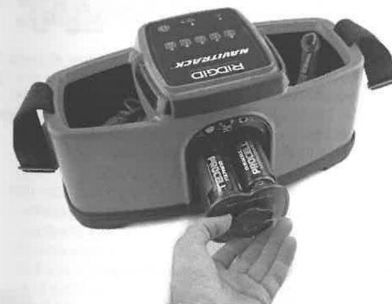
Ao substituir as pilhas, use 8 pilhas alcalinas D-cell do mesmo tipo. Não misture Alcalinas com NiCd, por exemplo. Certifique-se de que substitui com pilhas com a mesma carga. Não use pilhas meio usadas com pilhas novas.
