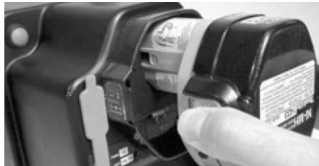
Figura 12 – Compartimiento de la batería
