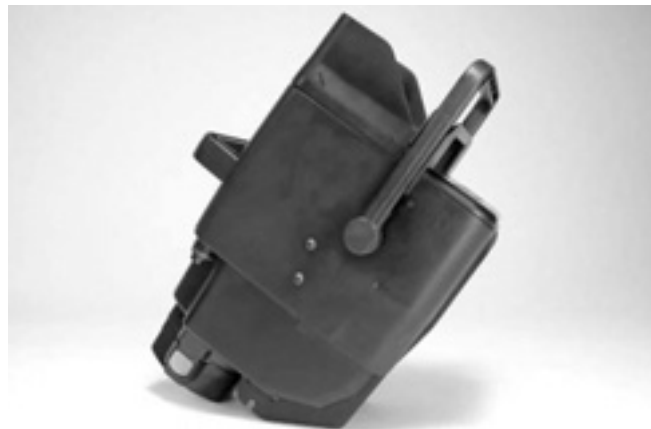
Figura 11 – Unidad Monitora afirmada sobre sus soportes traseros
