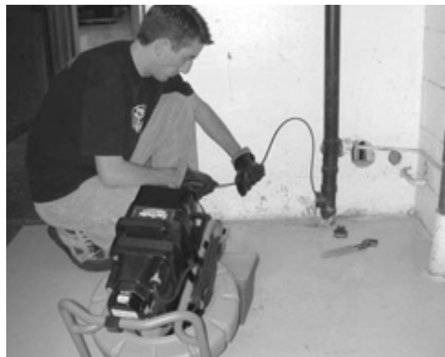
Figura 16 – Posición incorrecta para operar el equipo
