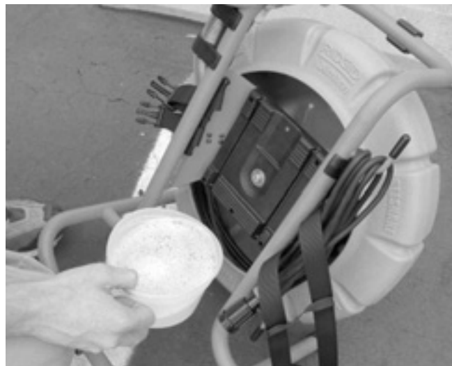
Figura 28 – Posición correcta para efectuar la limpieza
