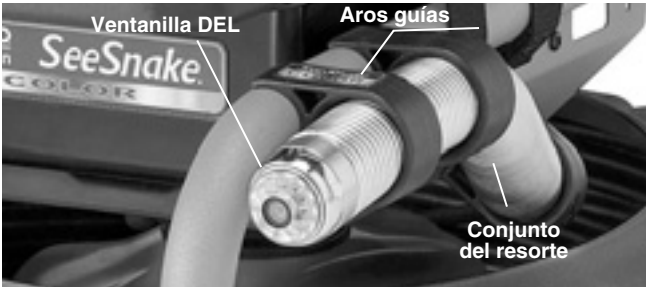
Figura 2 – Cámara en el cabezal
