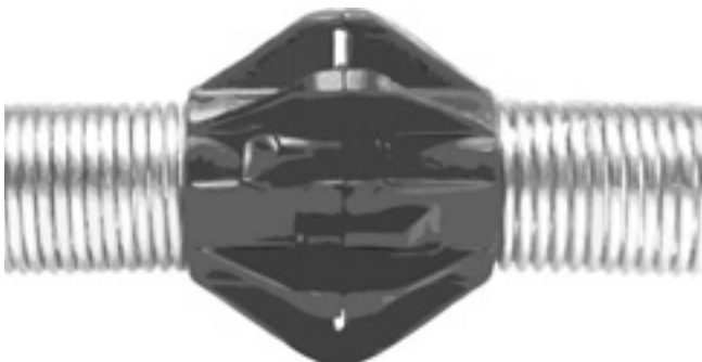
Figura 24 – Las guías de centrado mejoran la visibilidad al permitir que la cámara se levante del fango y vea igual cantidad de pared para todos lados. También disminuyen el desgaste de la ventanilla DEL.
