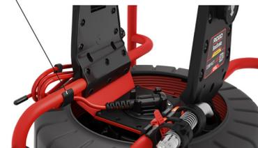
4. Tournez la bague de glissement du cadran dans le sens antihoraire jusqu'à la position déverrouillée 6.
