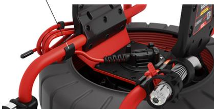
4. Drehen Sie den Schleifring gegen den Uhrzeigersinn in die Position „Unverriegelt“ **6**.
