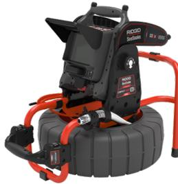
**Hinweis** Der Begriff Compact M40 wird in diesem Handbuch sowohl für die Compact M40 als auch für die Compact M40 DSL verwendet. Die Compact M40 DSL verfügt über einen digitalen selbstnivellierenden Kamerakopf, während der Kamerakopf der Compact M40 mechanisch nivelliert wird. Die Produkte sind ansonsten funktional identisch.
