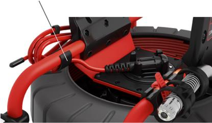
4. Gire el disco del anillo colector hacia la izquierda hasta la posición de desbloqueo 6.
