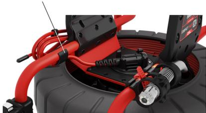
4. Ruotare il quadrante del collettore rotante in senso antiorario in posizione di sblocco 6.
