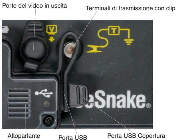
**Figura 5 – Connessioni del CS10**
