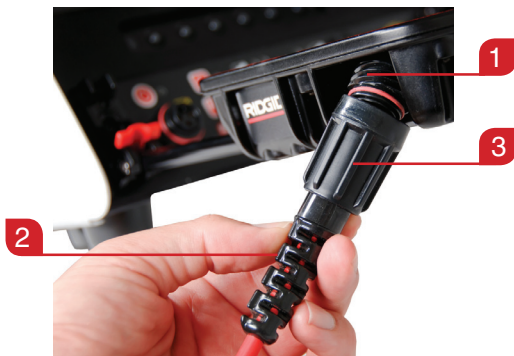
Figure 8 – Connexion du câble d'interconnexion sur le CS1000
