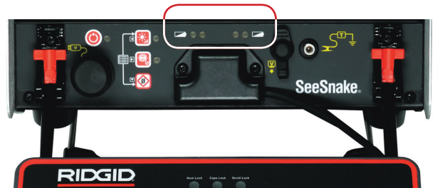
Afbeelding 11 – Indicatielampjes (led-lampjes) voor batterijen
