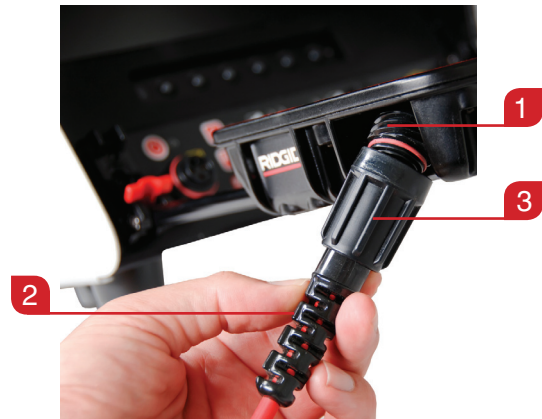
Afbeelding 8 – Aansluiten van de systeemkabel van SeeSnake op de systeemaansluiting van de CS1000
