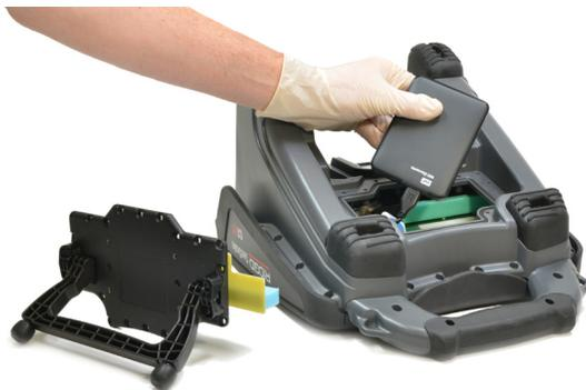
8. Far scivolare il disco rigido interno verso il basso e verso destra in modo che si inserisca nella sua collocazione protetta, fra gli inserti di schiuma, all'interno del sistema.
