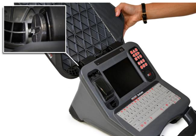
Per sostituire la copertura frontale, assicurarsi che le scanalature dei cardini siano allineate fra loro. Far scivolare la copertura nelle scanalature e poi tirare giù la copertura finché non scatta al suo posto.
