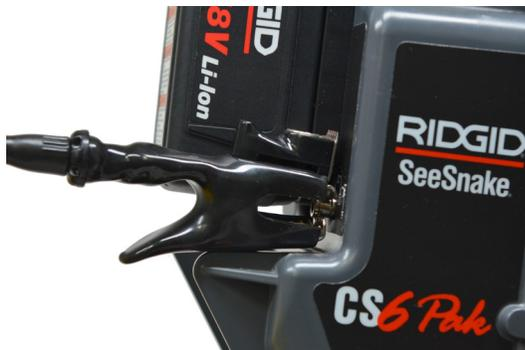
3. Accendere il trasmettitore e impostare la frequenza desiderata. Per ottenere migliori risultati usare frequenze di 33 kHz o superiori. Accendere il ricevitore e impostarlo sulla stessa frequenza del trasmettitore.
