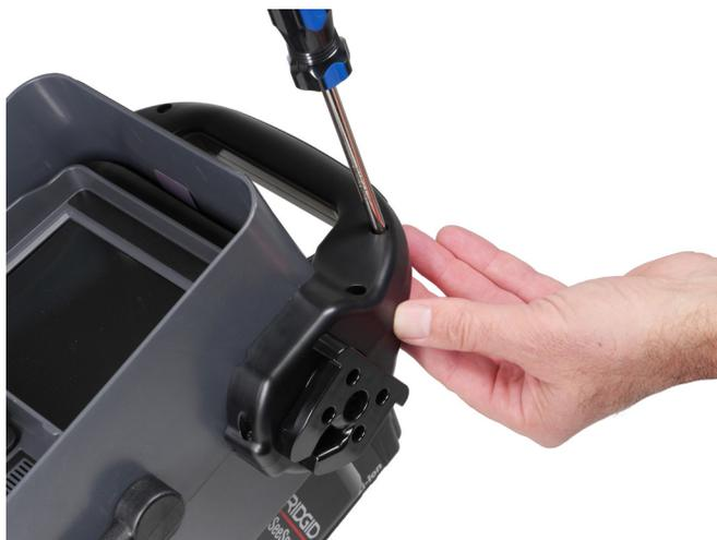
2. Separare le due metà della maniglia di ancoraggio, che racchiudono anche i due giunti di ancoraggio e l'inserto di gomma.
