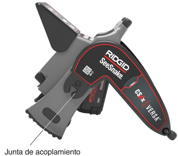
2. Centre el CS6x Versa sobre las aletas de acoplamiento y alinee las juntas de acoplamiento con los zócalos de unión.
