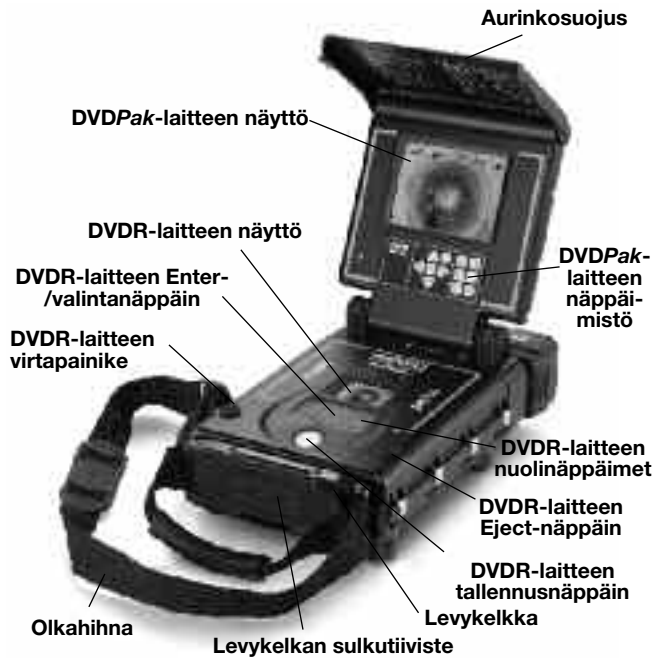
Kuva 1 - DVDPak-laitteen osat
