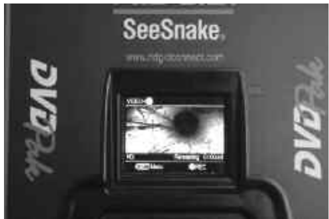
12. ábra – Kamerakép megjelenítése a DVDR kijelzőjén
