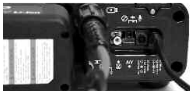
Slika 8 – Priključen kabel zunanjega napajanja
