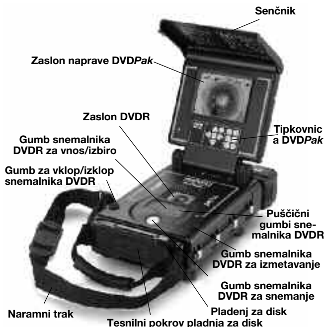
Slika 1 – Komponente DVDPak
