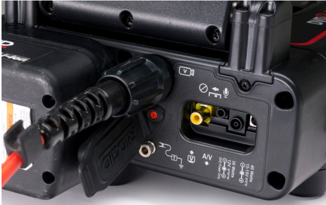
Figure 4 – Connecter le câble de système SeeSnake au DVD Pak 2
